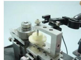
仅需输入模数 (DP) 和齿数即可开始测量，并快速得出测量结果。
